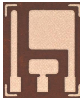
Obr. 63: Tisk Ag/AgCl pasty DuPont 5870 na kaptonový substrát (ZČU)
