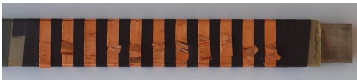
Obr. 6.14 Vzorek statorové tyče při měření V-A charakteristiky EGS ochrany
