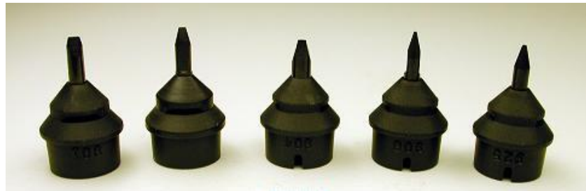
Obr. 18 Ukázky sacích trysek (nozzle)
