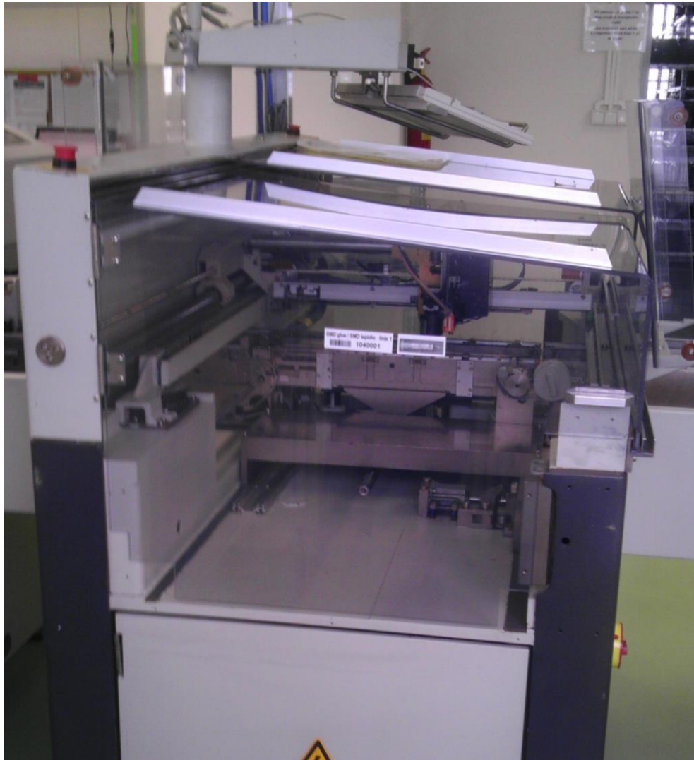
Obr. 12 Stroj na nanášení SMD lepidla
