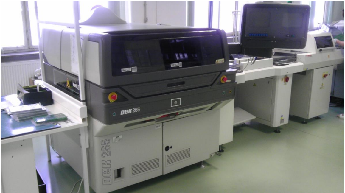
Obr. 4 Stroj na nanášení pájecí pasty
