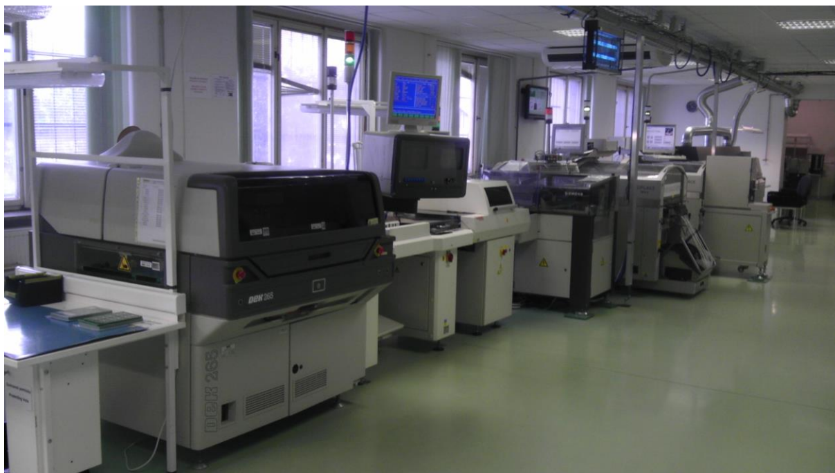
Obr. 1 Osazovací linka v řazení za sebou
