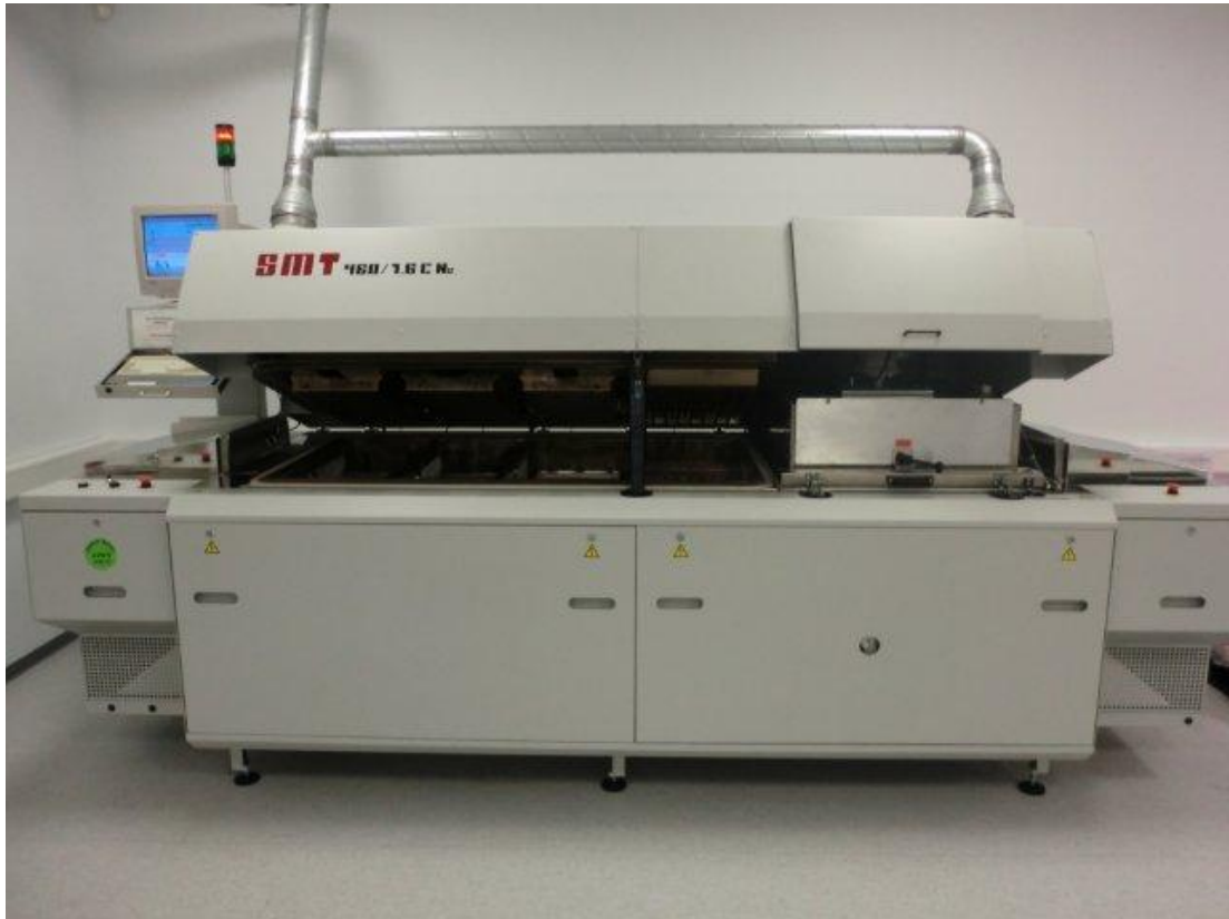
Obr. 23 Přetavovací pec (otevřená, zleva 4 topné sekce a 1 chladicí)
