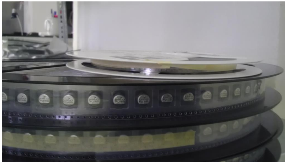
Obr. 13 Nejužší a nejširší pás se součástkami, navinutý na kotouči
