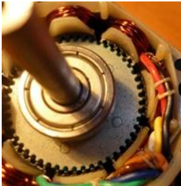
Obr. 3 Uložení rotoru ve statoru [15]
