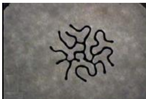
Obr. 3.2: Příklad obrazce vytvořeného ferokapalinou [25]
