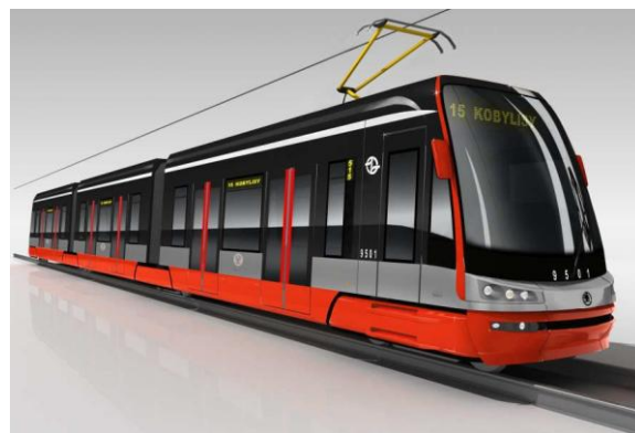
Obr. 19. Nízkopodlažní tramvaj 15T ForCity s trakčními PMSM (převzato z [11])
