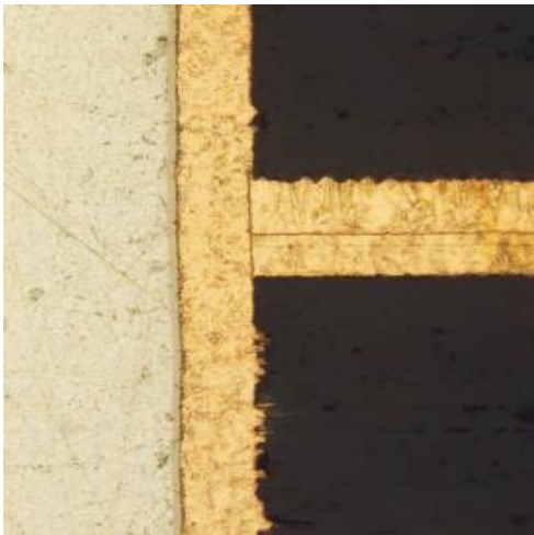
Obr. 15 Správně vyvrtaná díra bez „etchback“ jevu
