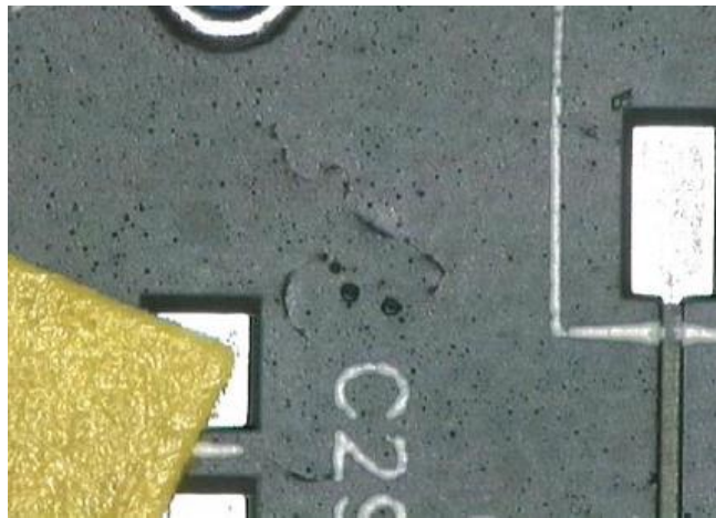
Obr. 5 Přijatelné nečistoty v desce
