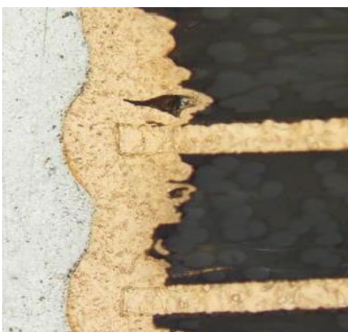
Obr. 16 „Etchback“ jev při špatném vyvrtání otvoru
