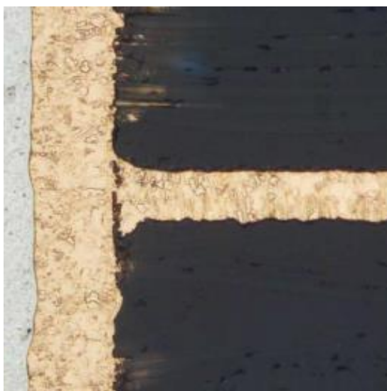
Obr. 18 Nepropojení mezi vodivou vrstvou desky a pokovením otvoru, které je nepřijatelné.
