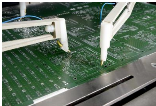
Obr. 25 Testování létající sondou [6]
