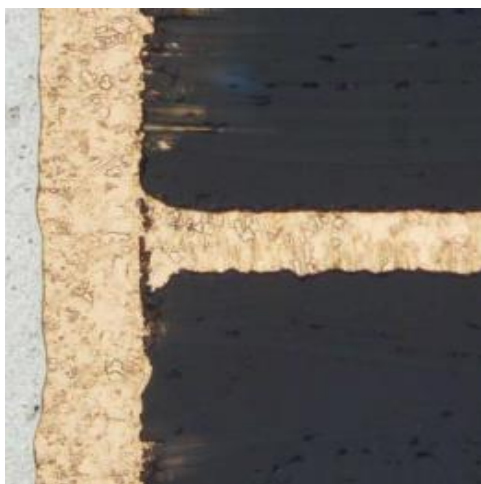
Obr. 18 Nepřijatelné propojení mezi vodivou vrstvou desky a pokovením otvoru [2]
