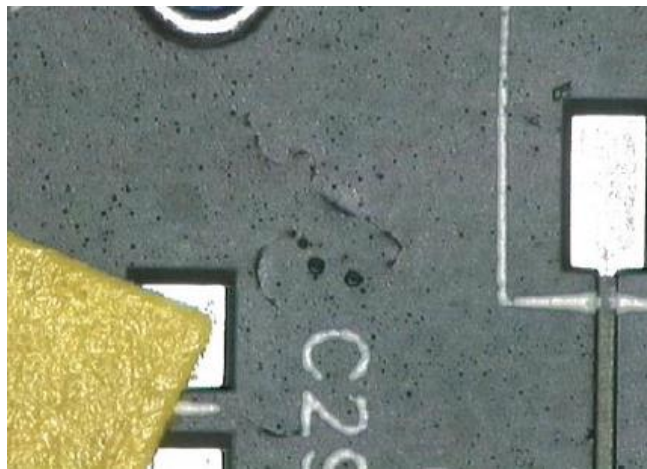
Obr. 6 Přijatelné nečistoty v desce [2]
