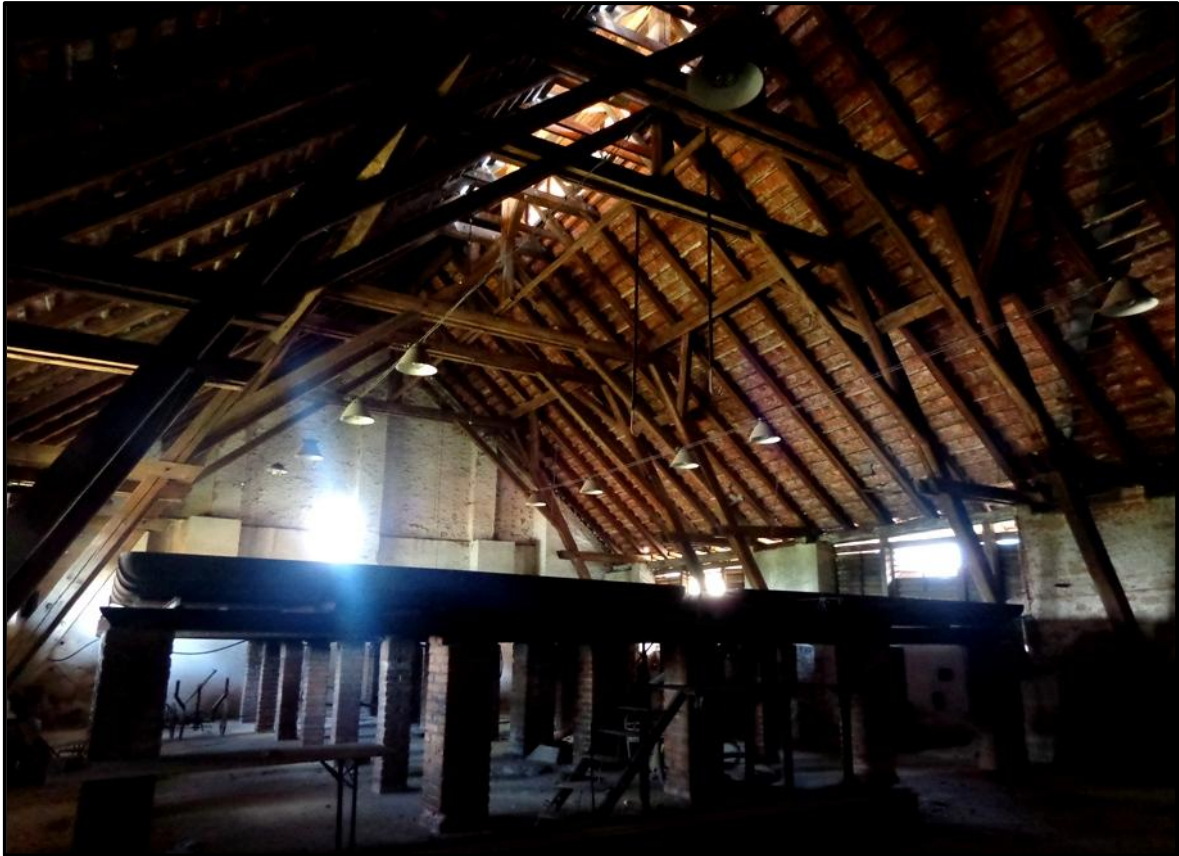
Obrázek 15: Chladicí štoky (80hl) od firmy Novák & Jahn. V současnosti jsou jediné funkční štoky v České republice v Praze v pivovaru u Fleků. V dnešní době jsou v pivovarech nahrazovány vířivými káděmi. Stav z června roku 2014. (Fotografie je uložena v soukromém archivu autorky této práce.)
