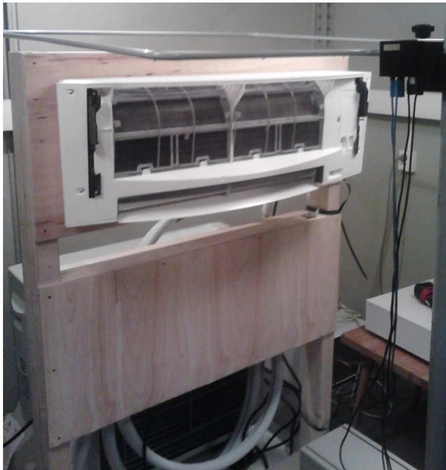
Obr.A1. Klimatizační jednotka při testu magnetického pole síťového kmitočtu
