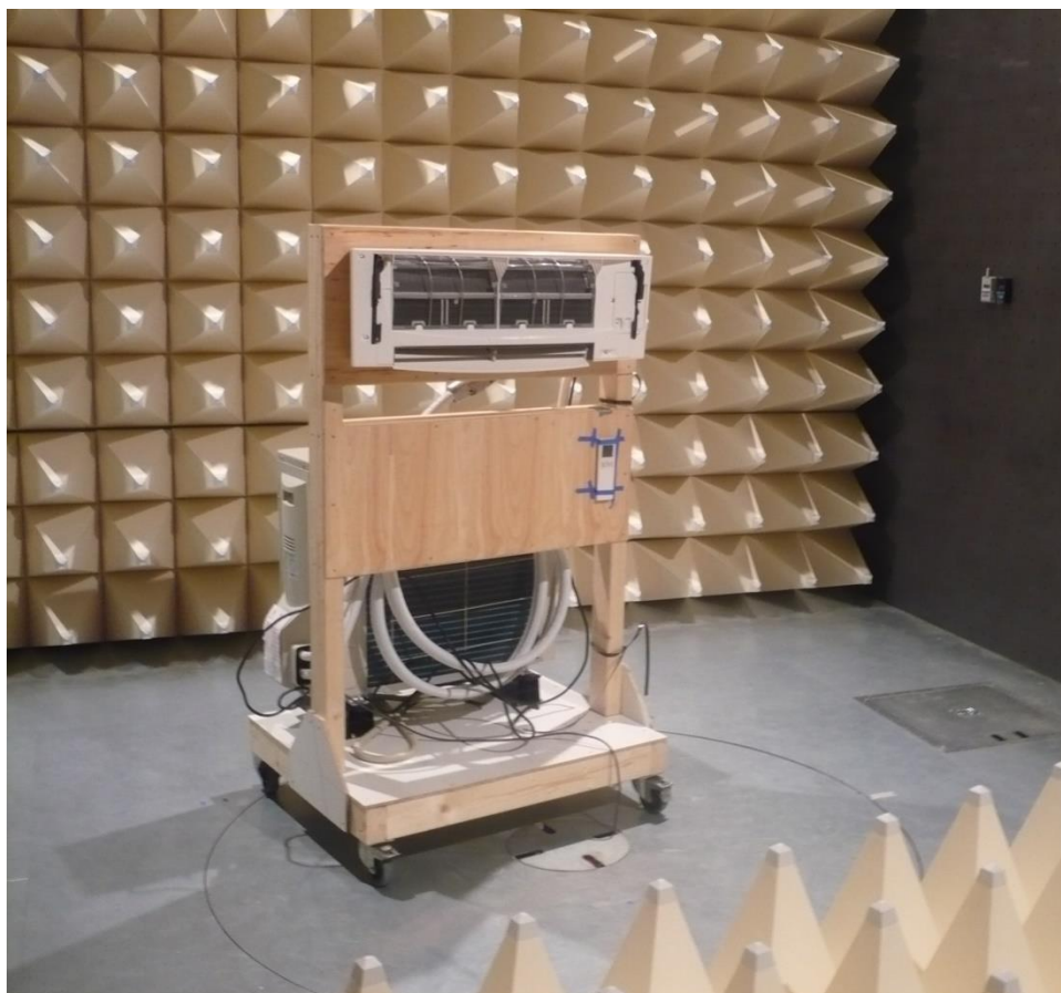
Obr.A3. Klimatizační jednotka na dřevěném podstavci v stíněné absorpční komoře
