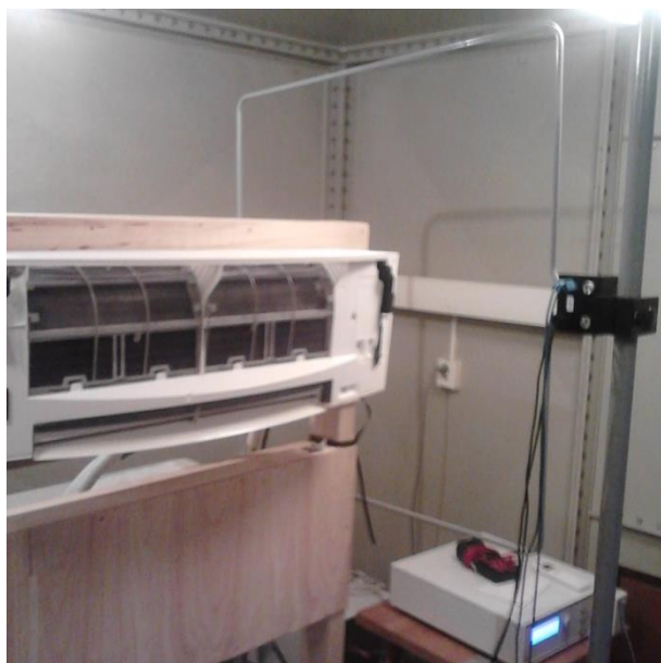
Obr. 23. Testování odolnosti magnetickým polem metodou přiblížení
