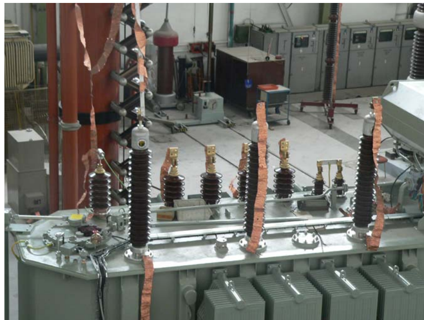
Obr. 26. Příklad zapojení zkoušeného výkonového transformátoru.
