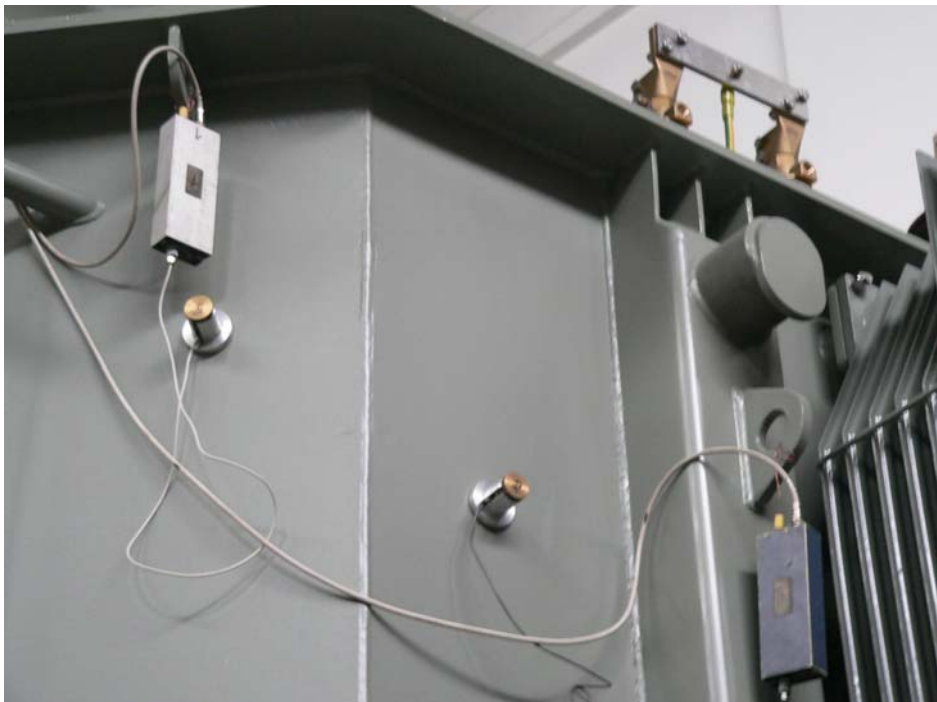
Obr. 33. Umístění akustických sond u metody akustických odezev
