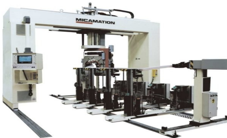
Obr. 1.5 Špičkový stroj na automatické ovíjení cívek generátorů s řízením pohybu v 6-ti osách. (převzato z [12]).
