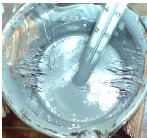
Obr. 2.10 MR kapalina MRHCCS4-B v magnetickém poli
