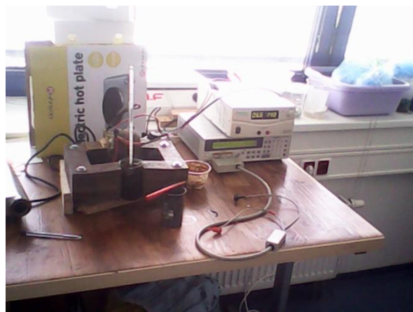
Obr. 2.5 Pracoviště pro měření poměrné permeability při různých hodnotách magnetické indukce
