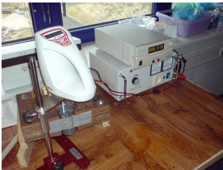
Obr 3.7 Pracoviště pro měření zdánlivé viskozity
