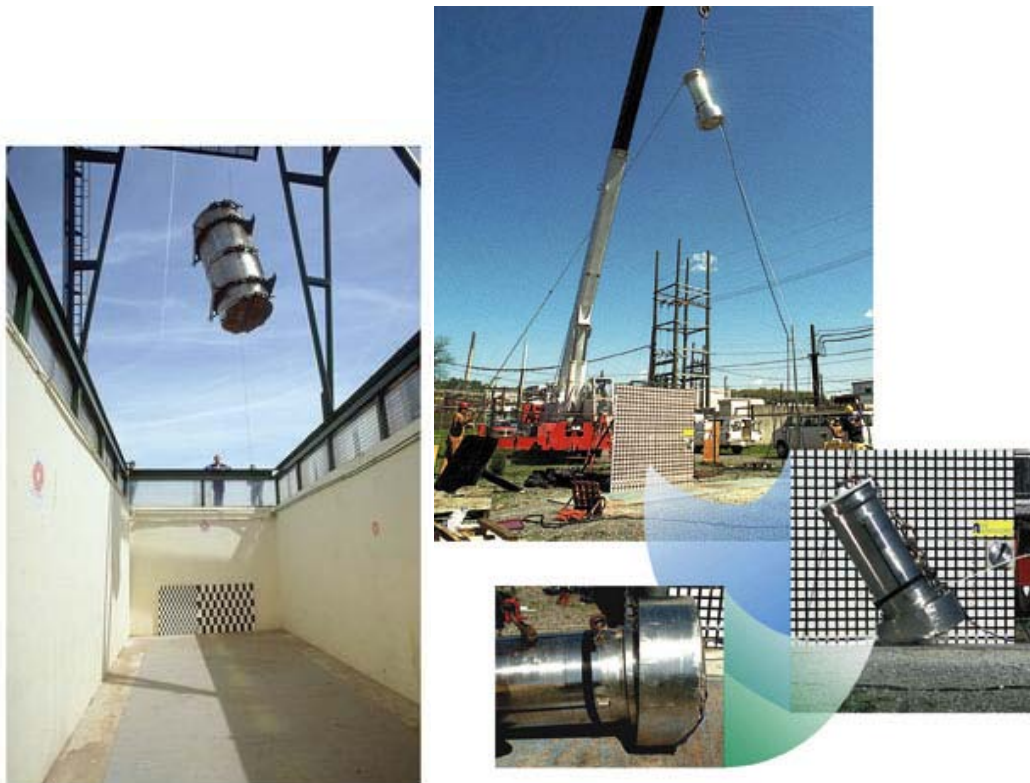
Obr. 4.1. Crash – test kontejneru na PJP. Pád z 9 m výšky [29][30].
