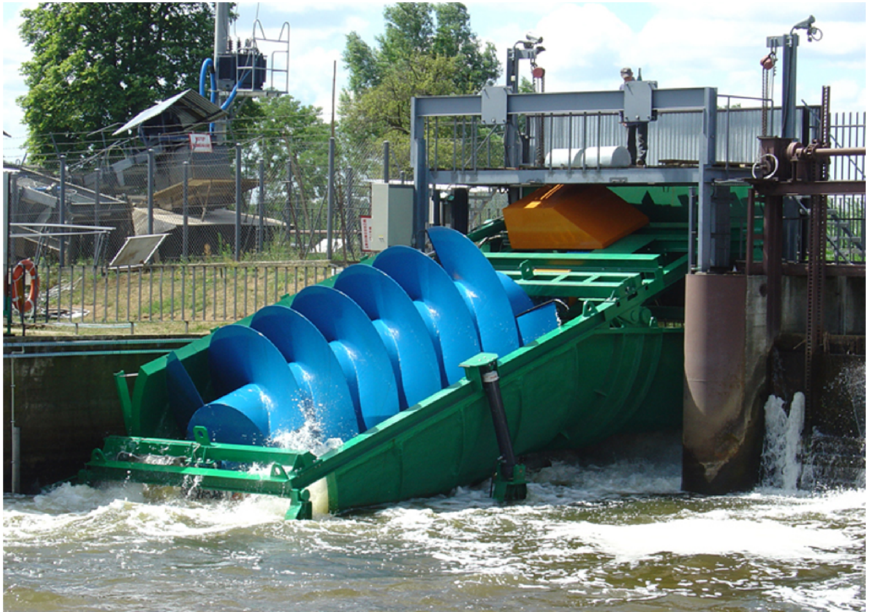
Obrázek 2.1-1 Šroubová turbína v ocelovém žlabu [18]
