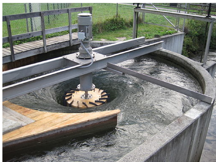
Obrázek 2.2-2 Vírová turbína v provozu u Ober-Grafendorfu [18]
