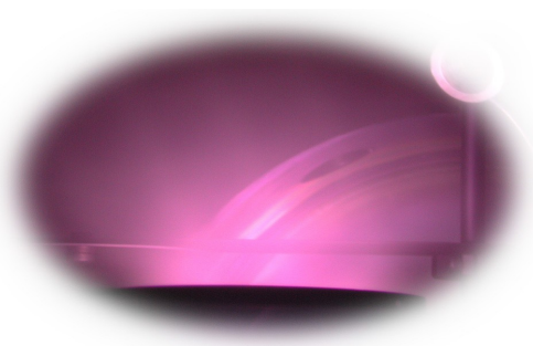
Obr. 13 Doutnavý výboj-depozice tenké vrstvy
