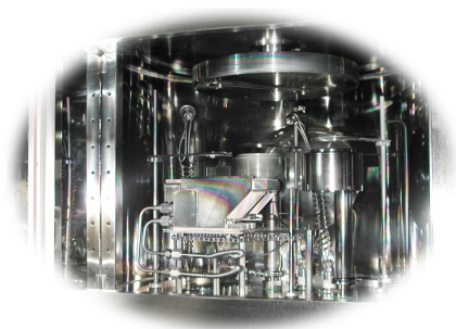
Obr. 12 Komora depozičního systému
