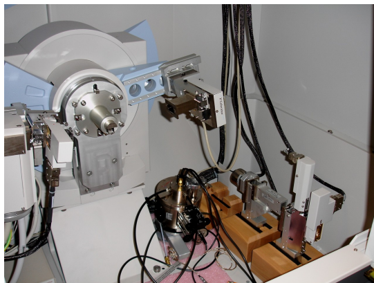
Obr. 18 Pohled do pracovního prostoru práškového difraktometru
