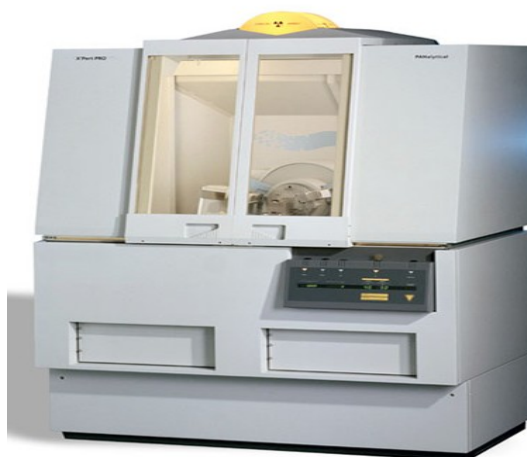
Obr. 17 Práškový difraktometer XPERT PRO
