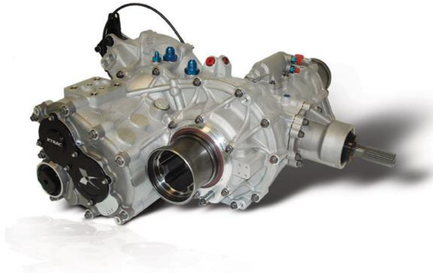
Obr. 1: Převodovka Xtrac 532 SUPER 2000 RALLY [34]
