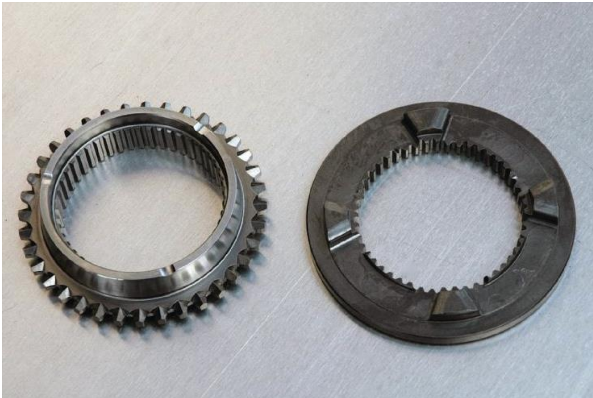
Obr. 15: Porovnání konvenčního přesuvníku s kuželovou synchronizací (vlevo) a přesuvníku závodní převodovky (vpravo)
