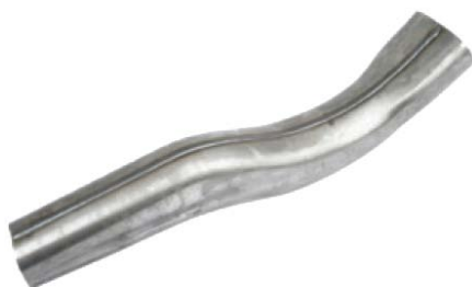
Obr. 3: Komponenta automobilu svařená technologií „laser-tandem-hybrid“ [10]
