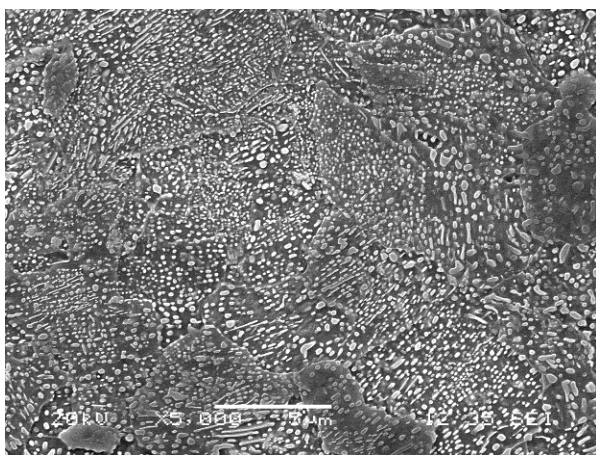
Obr. 137 Mikrostruktura vzorku 780-1×150s, 281 HV10
