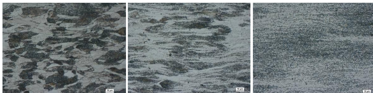
Obr. 32 Střed vzorku K1, e_{ef} = 1 Obr. 33 Střed vzorku K2, e_{ef} = 1,7 Obr. 34 Střed vzorku K3, e_{ef} = 2,9
