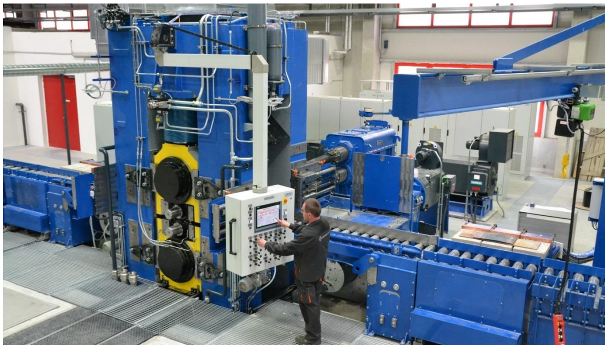
Obr. 40 Laboratorní válcovací trať v COMTES FHT a.s.
