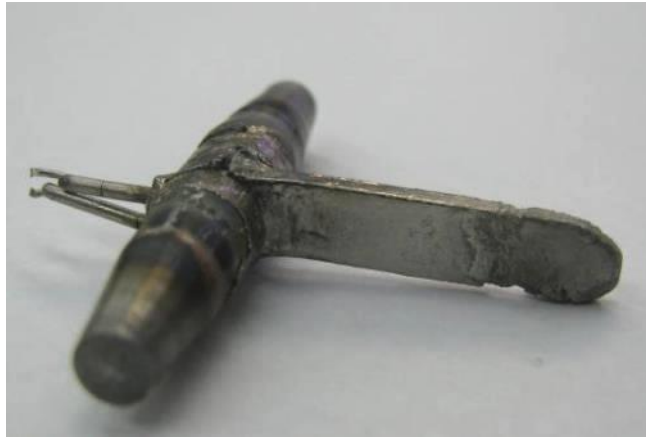
Obr. 48: Detail produktu při zvýšení tvářecí síly na 7,5 kN
