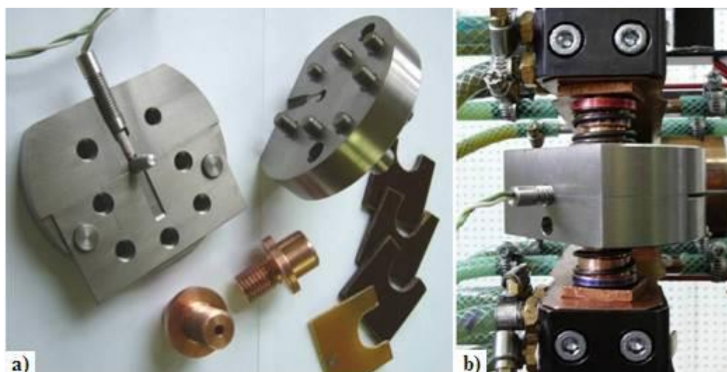
Obr. 37: Forma pro tváření v semi solid stavu a) rozložená forma s příslušenstvím, b) forma po instalaci do simulátoru
