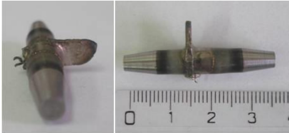
Obr. 44: Příklad neúplného vyplnění dutiny formy, teplota ohřevu 1290°C, tvářecí síla 5kN
