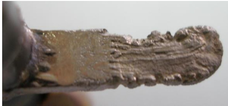
Obr. 46: Detail produktu při zvýšení teploty ohřevu na 1320 °C
