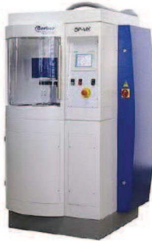
Obr.9 Kartáčovací stroj pro nástroje GERBER [24]
