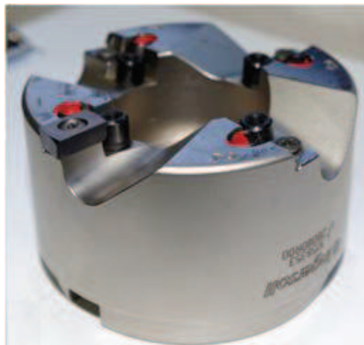
Obr.25 Frézovací hlava Ingersoll 6F2B080R00 [10]
