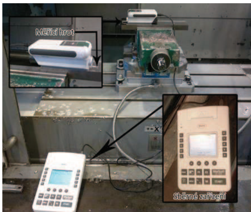
Obr.28 Drsnoměr Mahr MarSurf M300
