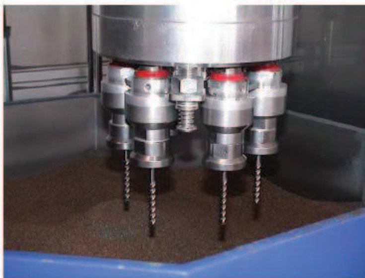
Obr.14 Pohled do zařízení omílání v granulátech [20]
