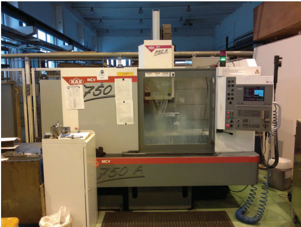
Obr.24 Vertikální obráběcí centrum MCV 750 A
