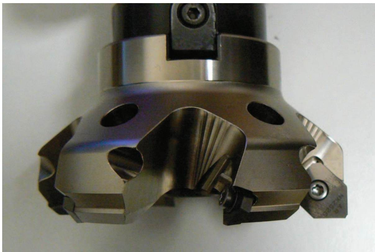
Obr.51 Frézovací hlava Mitsubishi ASX445-08OA06R
