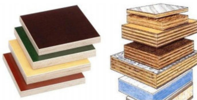
Obr. 16 Dřevěné jádro - překližka [43]
