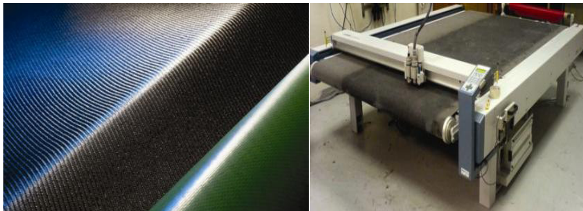
Obr. 9 Prepreg v rolích a řezací plotr Zund [27]
