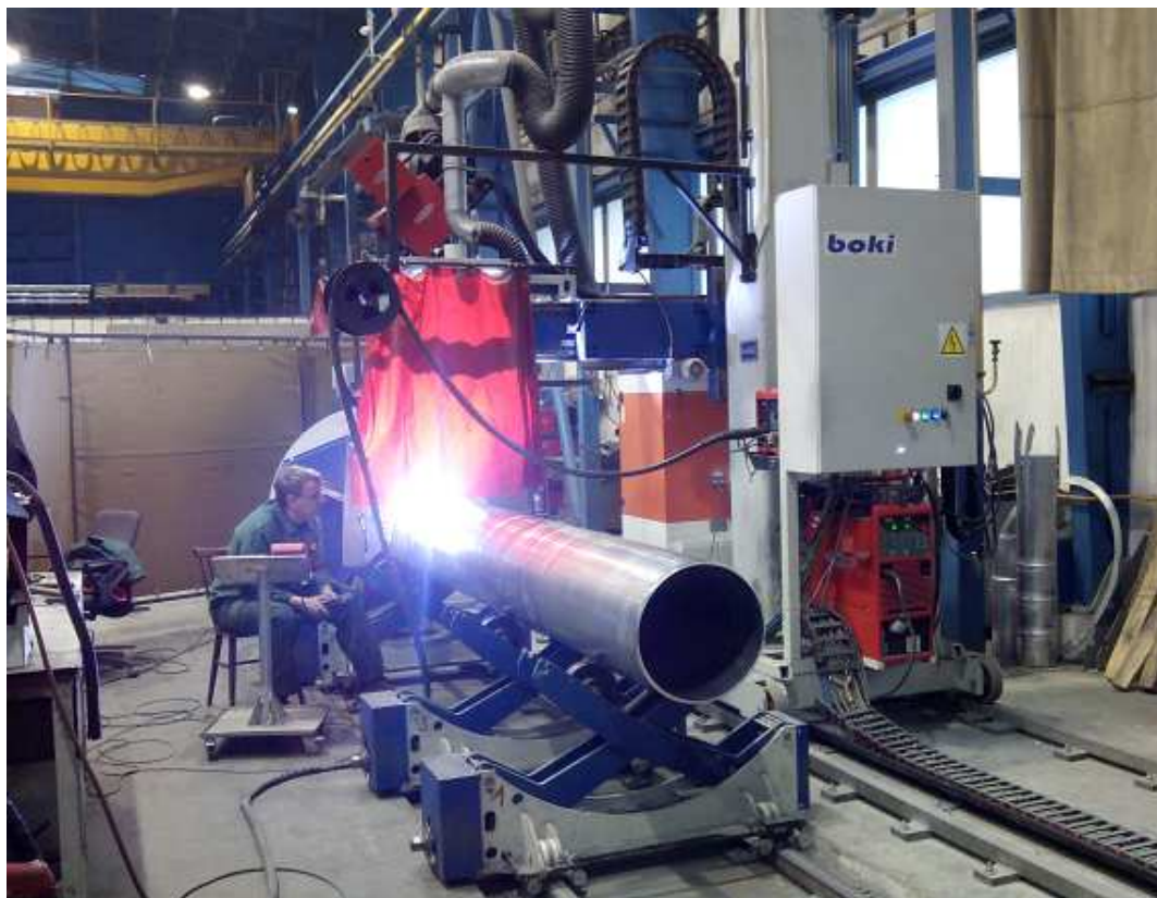
Obr. 25: Svařování vodičů svařovacím automatem
