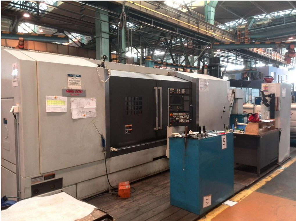
Obrázek 4.7: Použitý obráběcí stroj Mori Seiky NL3000
