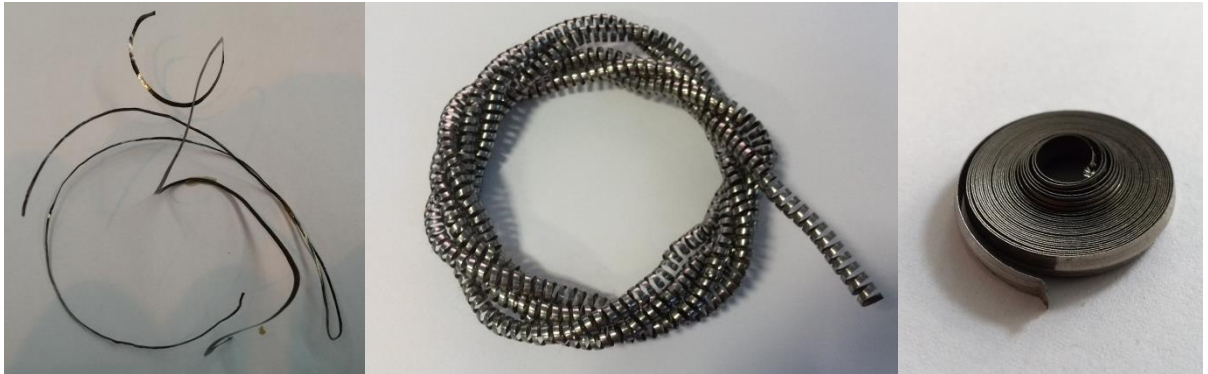
Obrázek 4.12: Tvarem méně žádané třísky - stužková, vinutá dlouhá a spirálová plochá tříska
