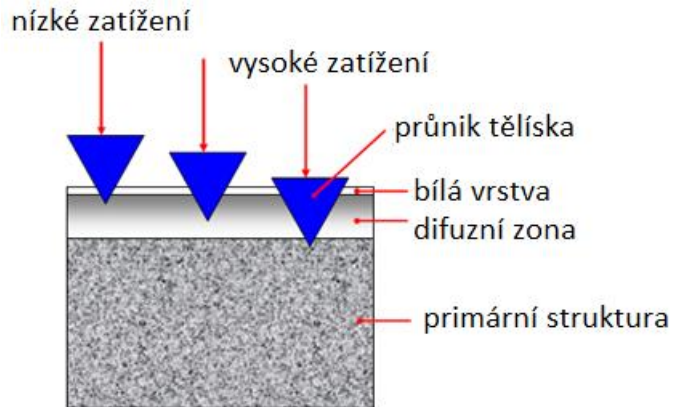
Obrázek 6.7. Zatížení při zkoušce tvrdosti [12]
