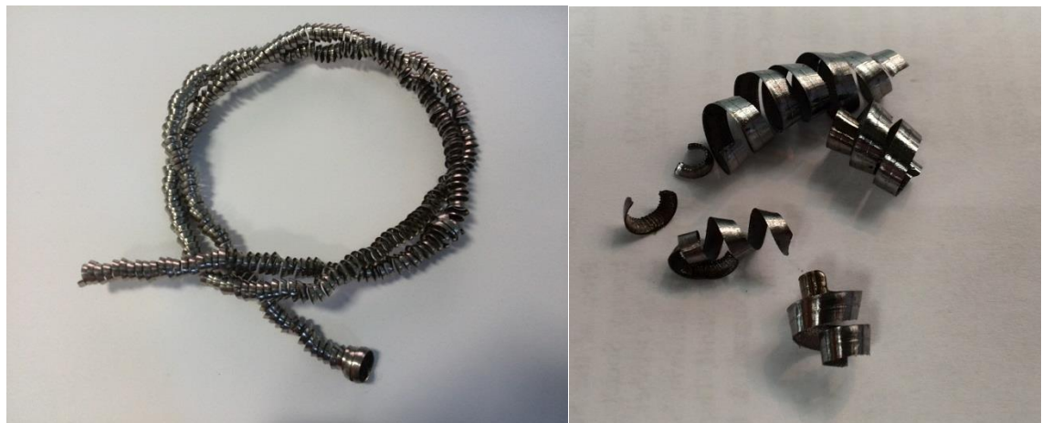
Obrázek 4.13: Žádaný tvar třísek - kuželovitá šroubovitá a dělená tříska
