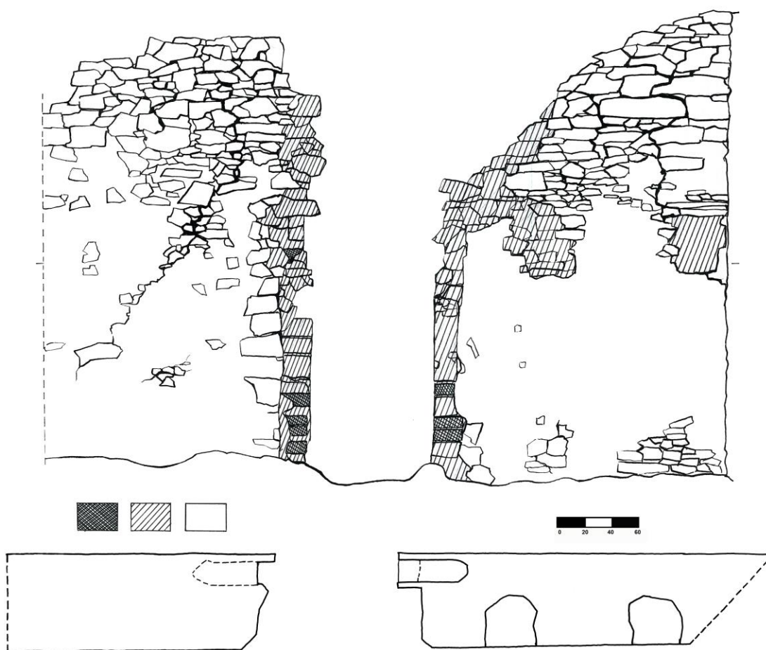
Obr. 35. Jižní vchod, kapsy (interiér, měřítko 1:20)
