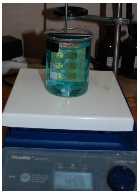
Obr. 11 Uchycení desek při vyvolání a leptání.
