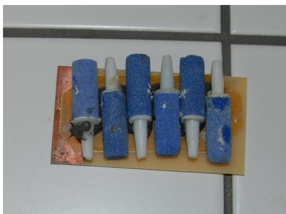
Obr. 12 Provzdušnění pomocí vzduchovacích válců.
