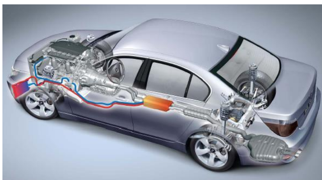
Obr. 4.1 Návrh sekundárního chladicího okruhu pro TEG automobilky BMW. [6]
