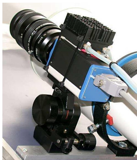
Obr. 3.19 Digitální fotoaparát součástí teleskopu pro pozorování noční oblohy. [12]
