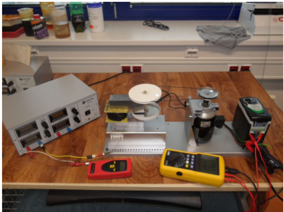
Obrázek 6.2: Sestava pro měření magnetoreologické brzdy
