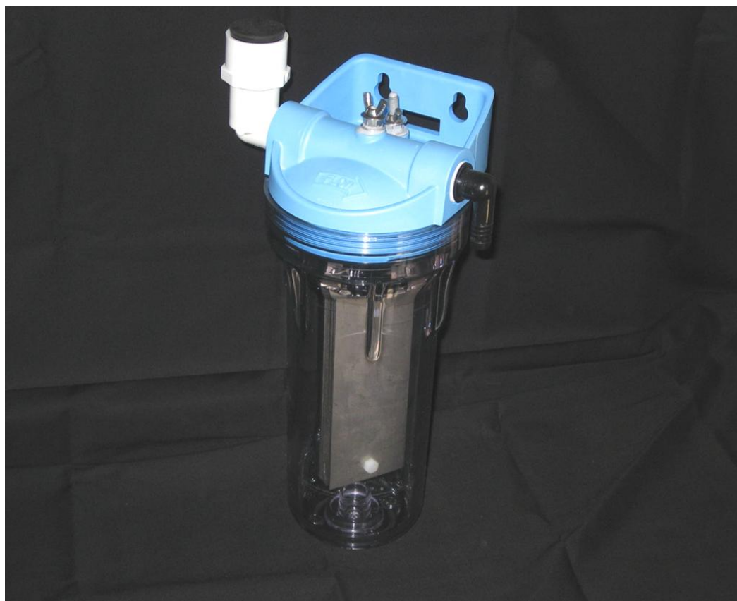
Obr. 1.9 Konstrukce mokrého článku (převzato z [16])
