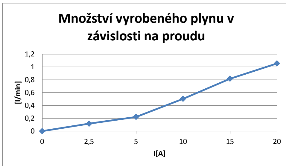
Obr. 3.10 Množství vyrobeného plynu v závislosti na proudu
