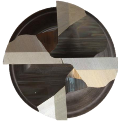
Obr. 1 Zobrazenie frézy po ostrení – naoštrená fréza
