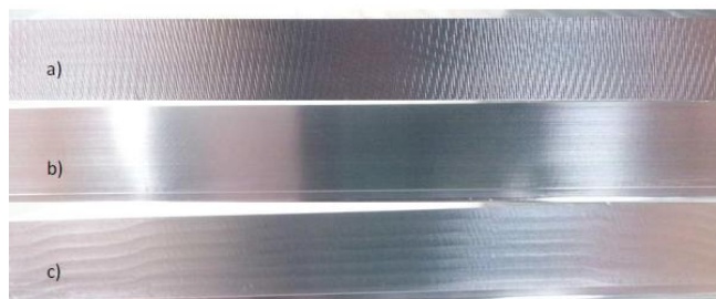
Obr. 8 Obrobené plochy vzorky pri v_c = 400 \text{ m.min}^{-1} , f_z = 0,05 \text{ mm} : a) \lambda_s=10^\circ , b) \lambda_s=20^\circ , c) \lambda_s=30^\circ Fig. 8 Machined surfaces when v_c = 400 \text{ m.min}^{-1} , f_z = 0,05 \text{ mm} : a) \lambda_s=10^\circ , b) \lambda_s=20^\circ , c) \lambda_s=30^\circ
