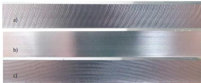
Obr. 9 Obrobené plochy vzorky pri v_c = 400 \text{ m.min}^{-1} , f_z = 0,1 \text{ mm} : a) \lambda_s=10^\circ , b) \lambda_s=20^\circ , c) \lambda_s=30^\circ Fig. 8 Machined surfaces when v_c = 400 \text{ m.min}^{-1} , f_z = 0,1 \text{ mm} : a) \lambda_s=10^\circ , b) \lambda_s=20^\circ , c) \lambda_s=30^\circ
