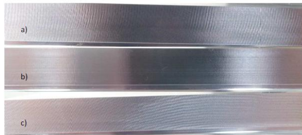
Obr. 7 Obrobené plochy vzorky pri v_c = 200 \text{ m.min}^{-1} , f_z = 0,1 \text{ mm} : a) \lambda_s=10^\circ , b) \lambda_s=20^\circ , c) \lambda_s=30^\circ Fig. 7 Machined surfaces when v_c = 200 \text{ m.min}^{-1} , f_z = 0,1 \text{ mm} : a) \lambda_s=10^\circ , b) \lambda_s=20^\circ , c) \lambda_s=30^\circ
