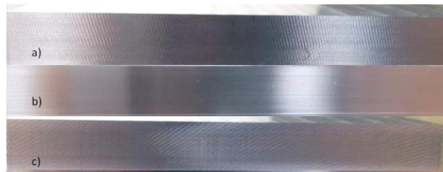
Obr. 6 Obrobene plochy vzorky pri v_c = 200 m.min -1 , f_z = 0,05 mm: a) \lambda_s = 10^\circ , b) \lambda_s = 20^\circ , c) \lambda_s = 30^\circ
