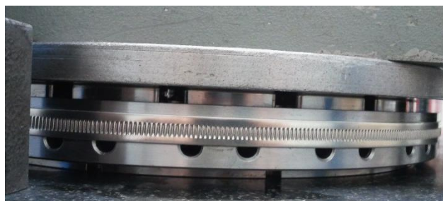
Obr. 18: Kontrola přilehnutí desky pomocí spárových měrek a na průsvit
