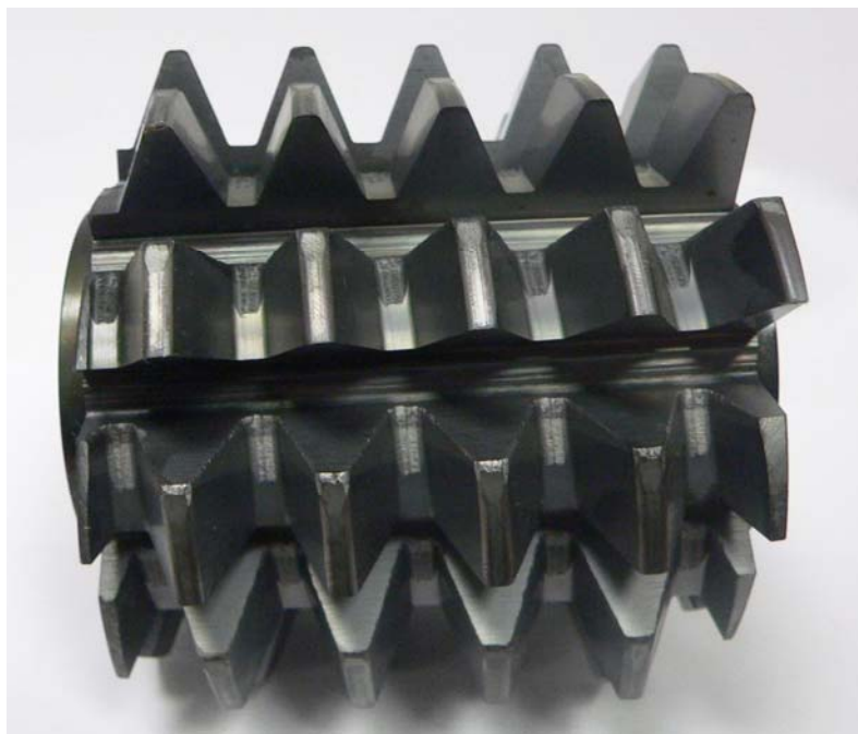
Obr. 8: Pohled na vyrobenou odvalovací frézu
