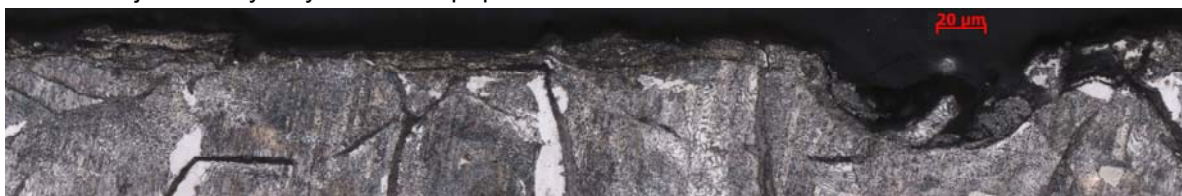
Obr. 11 – Stopy zpevnění povrchu a „vytržení“ povrchu u litiny následkem vrtání speciálním nástrojem
