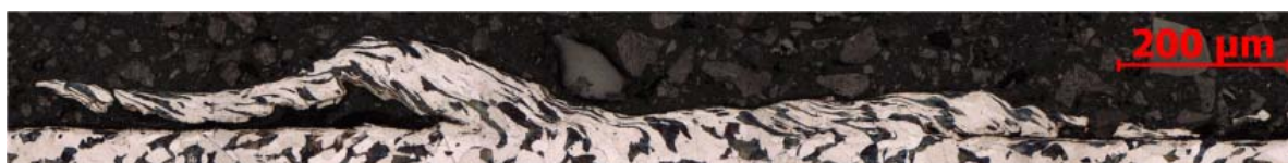
Obr. 18 – Oddělení zpevněného, obrobeného povrchu ve vyvrtané díře u oceli 12050
