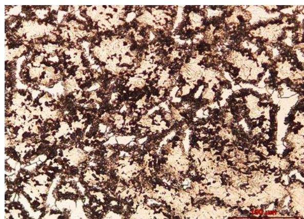
Obr. 7 – Struktura byla tvořena hrubými zrn, jehlicovitou fází a troostitem
