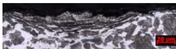
Obr. 14 – Tříška uchycená ve vytvořené stopě po obrábění
