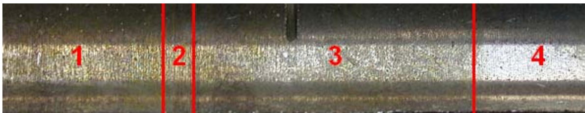
Obr. 21 - Povrch vyvrtané litiny ČSN 422420 - oblast 1 – pouze vrtáno; oblast 2 – přechodová oblast do tvářeného povrchu; oblast 3 tvářený povrch; 4 – zahlazený povrch.
