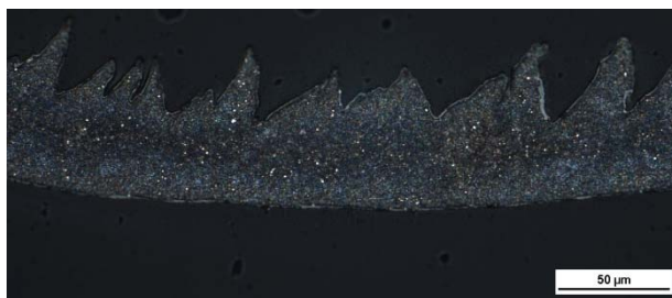
Fig. 11 Photos of chips in the different stages of cutting process Obr. 11 Fotografie triesok v počiatočnom a konečnom štádiu rezného procesu v_c = 100 \text{ m}\cdot\text{min}^{-1} , a_p = 0,075 \text{ mm}
