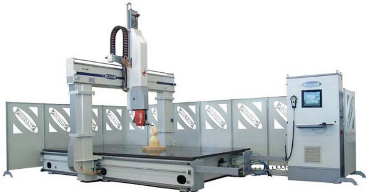
Obr. 2 - Koncepce s výklopnou hlavou ve dvou osách
