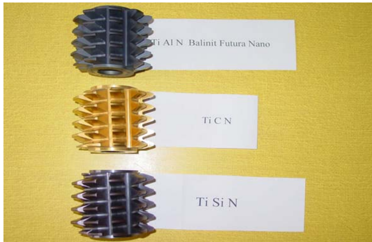
Obr. 9. Odvalovací frézy s různými typy povlaků
