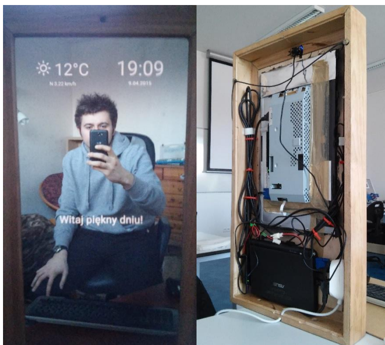
Rys. 2. Zdjęcia prezentujące działające urządzenie oraz wnętrze lustra.
