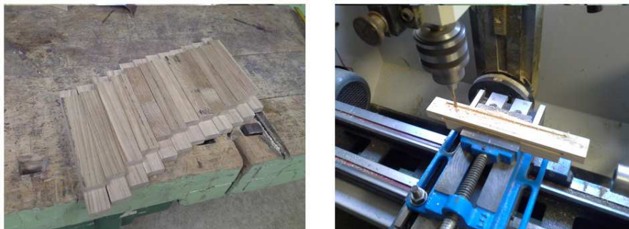
Obrázek 5 - Latě s čepem a rozporem; frézování drážek
