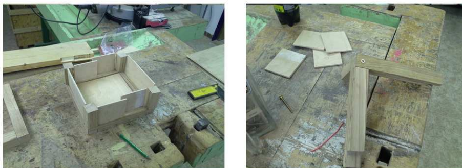
Obrázek 6 - Zkouška sezení destiček; spojování vrutem
