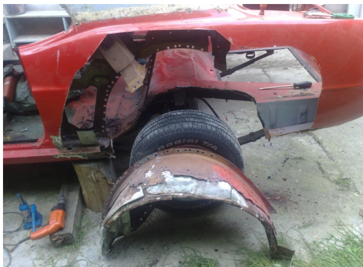
Obr. 1 : Poškodenia karosérie a podblatníka
