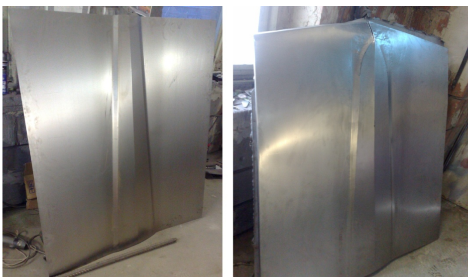
Obr. 2 : Výroba plášťa prednej kapoty
