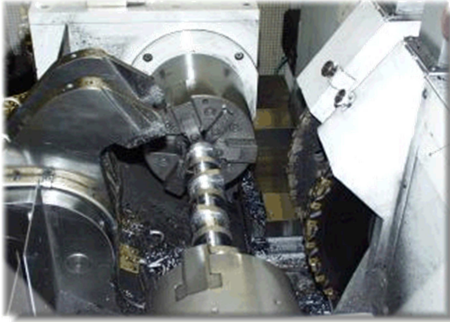
Obr. 36 - Frézovací stroj na obrábění klikových hřídelí frézou s vnějšími břity [ 2]
