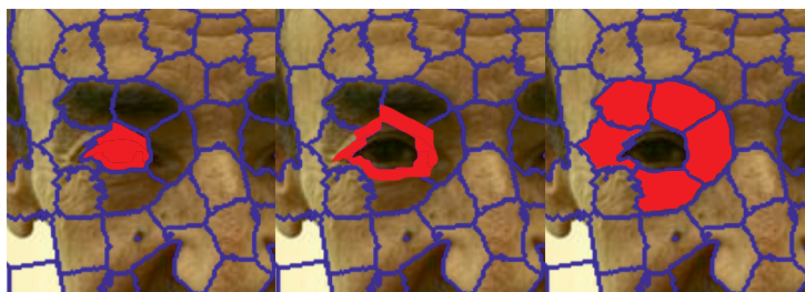
Obrázek 3.2: Hledání sousedu dilatací superpixelu. Vlevo superpixel jehož sousedy hledáme, uprostřed dilatace, vpravo sousední superpixely.
