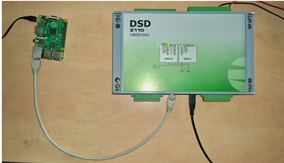
Obrázek 5.19: Výsledný obvod pro HIL simulaci
