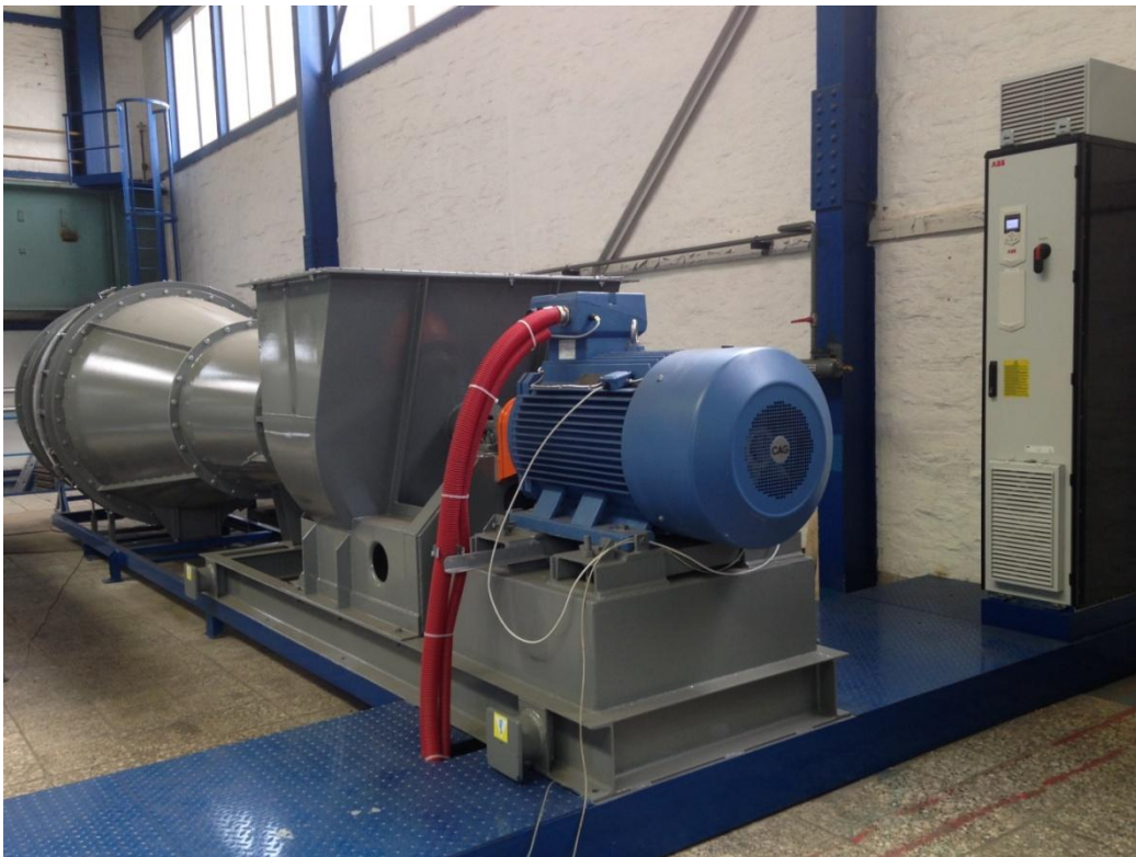
Obrázek 9: Zařízení pro kalibraci pneumatických sond
