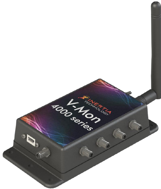
Obrázek 4.1: Bezdrátová senzorová jednotka V-Mon 4000
