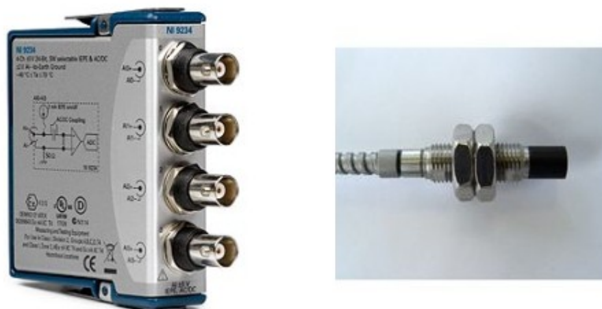
Obrázek 2-5: Měřicí karta NI 9234 [8] a snímač relativních vibrací PR 6423 [6]
