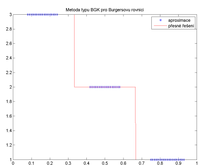
Obrázek 4.31: Aproximace přesného řešení Burgersovy rovnice metodou BGK pro \lambda = 1
