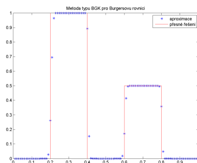
Obrázek 4.12: Aproximace přesného řešení Burgersovy rovnice metodou BGK pro \lambda = 1/50
