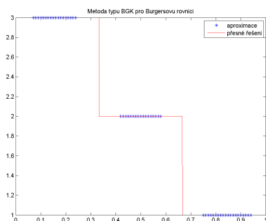
Obrázek 4.27: Aproximace přesného řešení Burgersovy rovnice metodou BGK pro \lambda = 1/2
