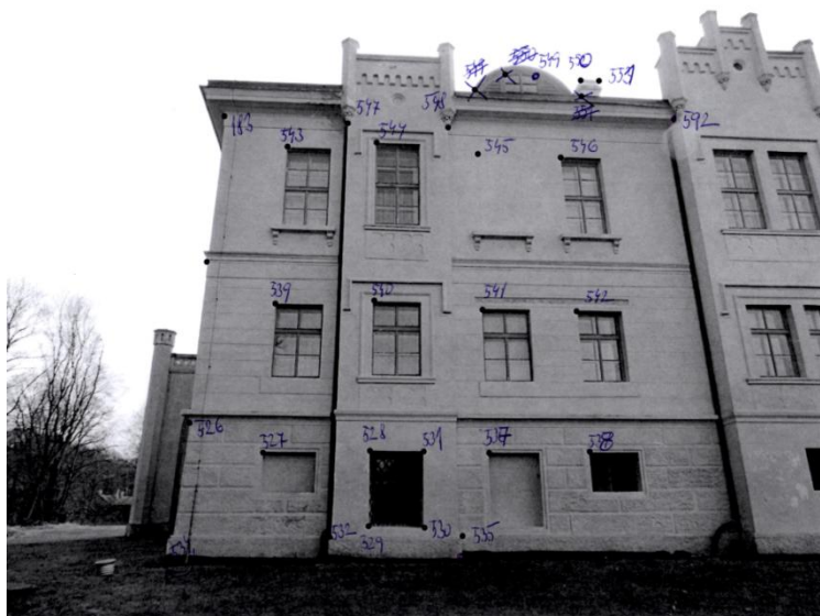
Obr. 2.5 Ukázka pracovního náčrtu měření podrobných bodů na fasádě zámku (Foto: Ing. Martina Vichrová Ph.D.)
