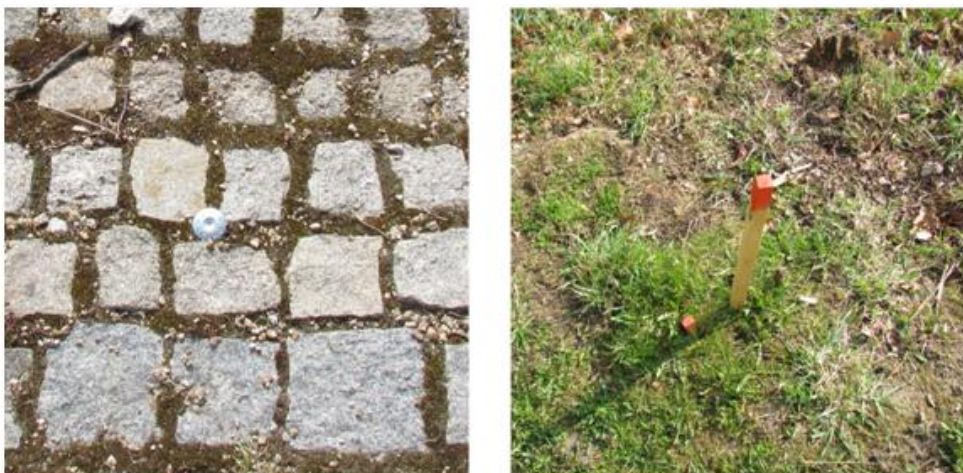
Obr. 2.1 Ukázky stabilizace bodů měřické sítě (Foto: Ing. Martina Vichrová Ph.D.)
