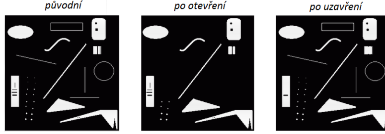
Obr. 2.6: Ukázka použití morfologického operátoru otevření a uzavření. Převzato z [26].
