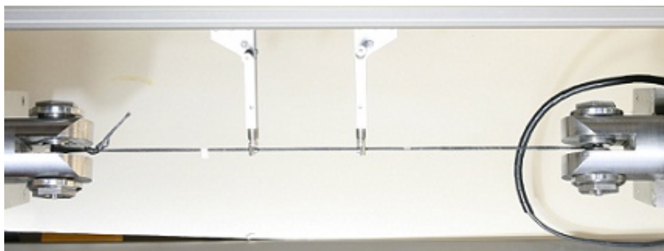
Obrázek 6.1: Tětiva před začátkem tahové zkoušky
